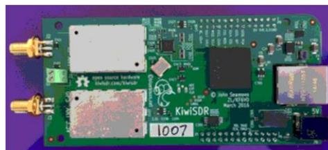
Además de algún hardware como un dispositivo USB como receptor, se necesitará una PC con software para "decodificar" las señales recibidas. Software disponible: HSDR, Airspy o KiwiSDR.
